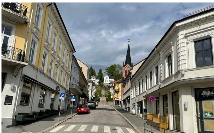
Byggehøyder langs Telemarksgata varierer og viser gatetverrsnitt der forhold mellom fasadehøyde og gatebredde varierer fra 3:5 til 1:1.
